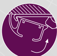
Eenvoudig te monteren: inklikken-positioneren-vastzetten
